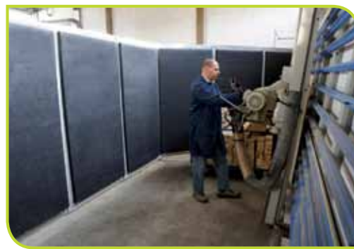
Isolamento acustico interno per macchina taglio legno
